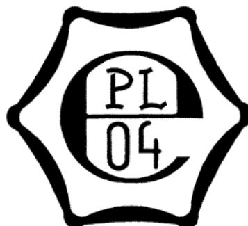
Rysunek 3. Wzór cechy legalizacji, która może być umieszczana na materiałnych miarach długości
